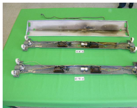
(写真2) 蛍光灯を展開し正常 品(下)と比較
