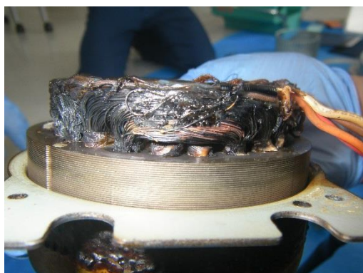
モーター焼損部分
