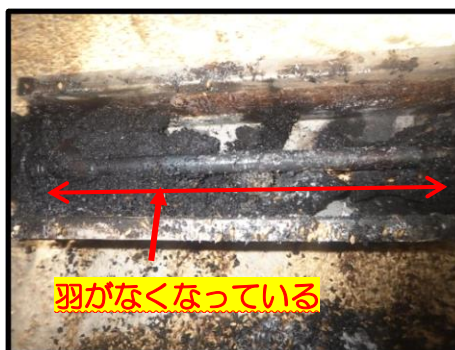
写真2 羽の摩耗状況
