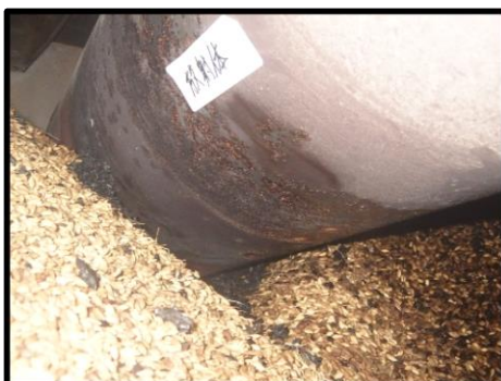
写真1 放射体との接触状況
