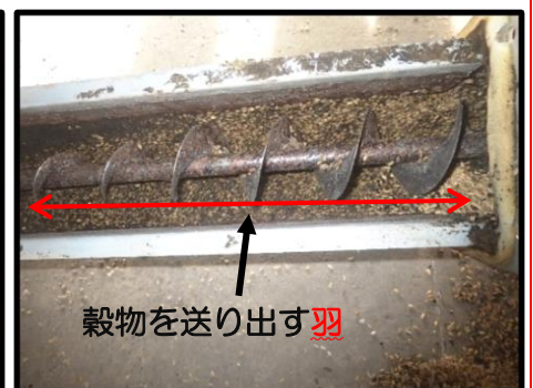
写真3 羽の摩耗状況
